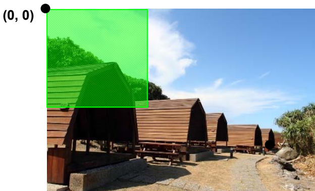
图 4-51: 来源 0 从图层 1 的(0,0)到(199,199),来源 1 从图层 2(0,0)到(199,199),在 alpha 值为 16 下,使用 alpha blending 并且显示在目的地, 图层 1 的[(0,0)到(199,199)]。
